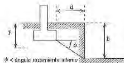
CONDICIÓN DE PROXIMIDAD DE CIMIENTOS A EXCAVACIÓN SIN ENTIBACIÓN ESPECÍFICA
