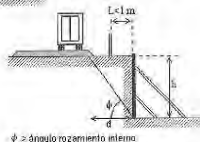
CONDICIÓN DE PROXIMIDAD DE CIMIENTOS A EXCAVACIÓN SIN ENTIBACIÓN ESPECÍFICA
