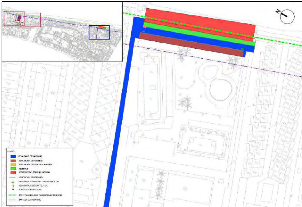
Planta demoliciones. Plaza Zoco Levante.
