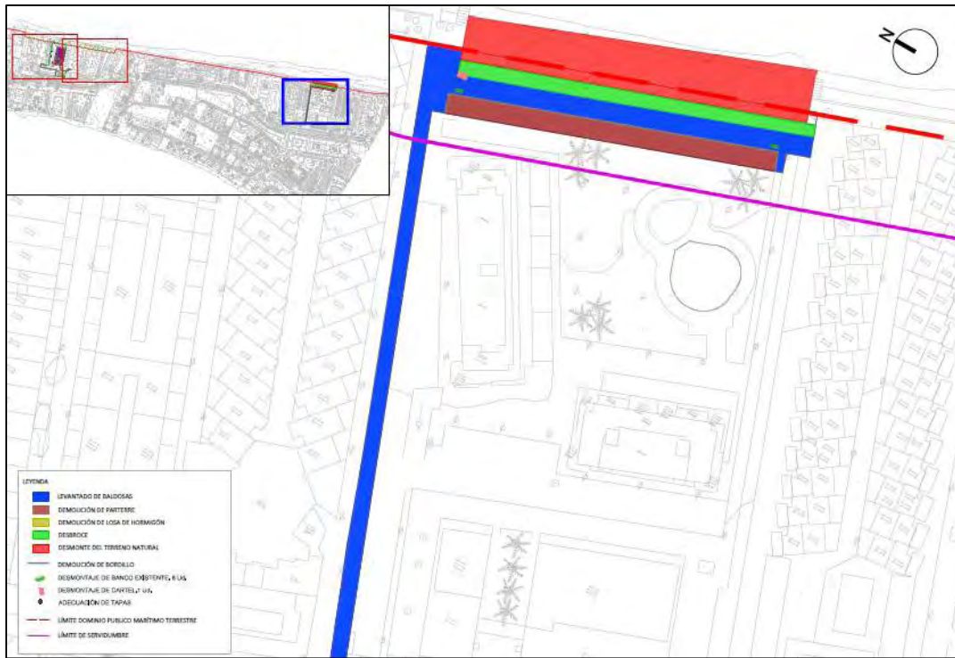
Planta demoliciones. Plaza Zoco Levante.
