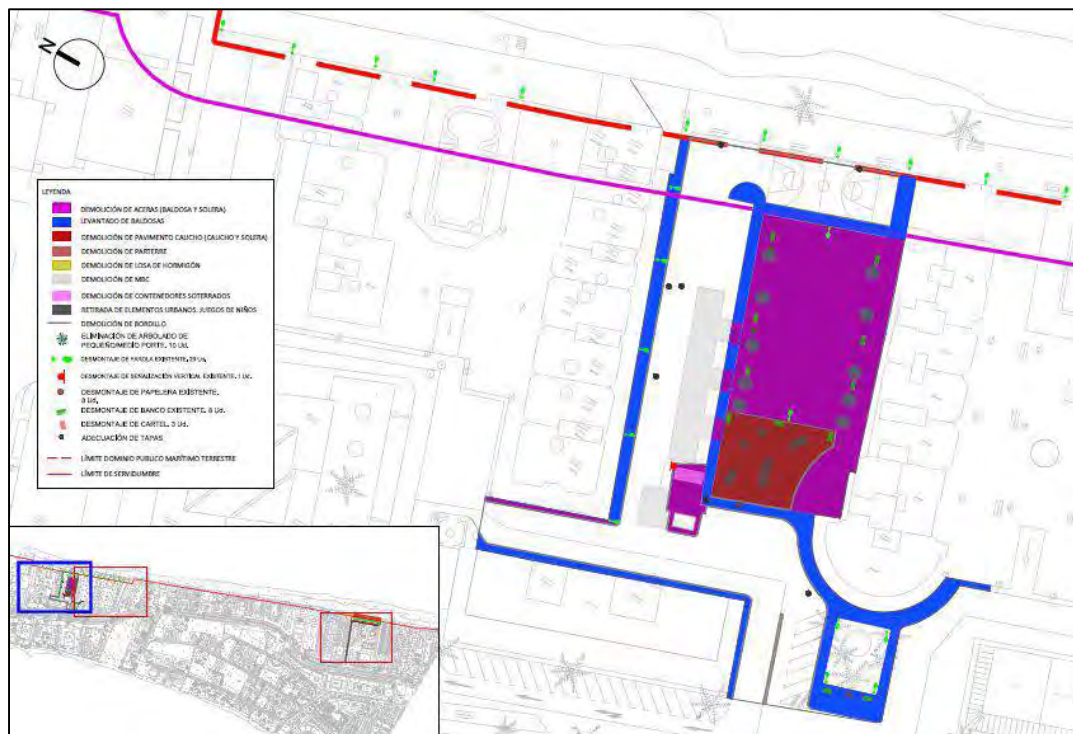
Planta demoliciones. Plaza Castillos del Mar.
