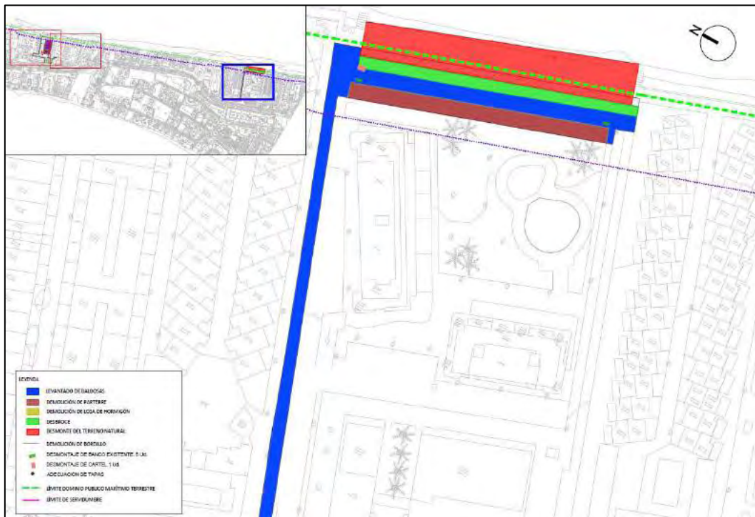
Planta demoliciones. Plaza Zoco Levante.
