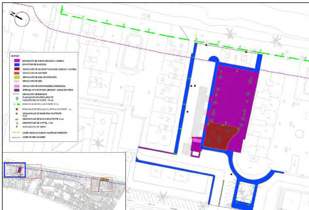
Planta demoliciones. Plaza Castillos del Mar.
