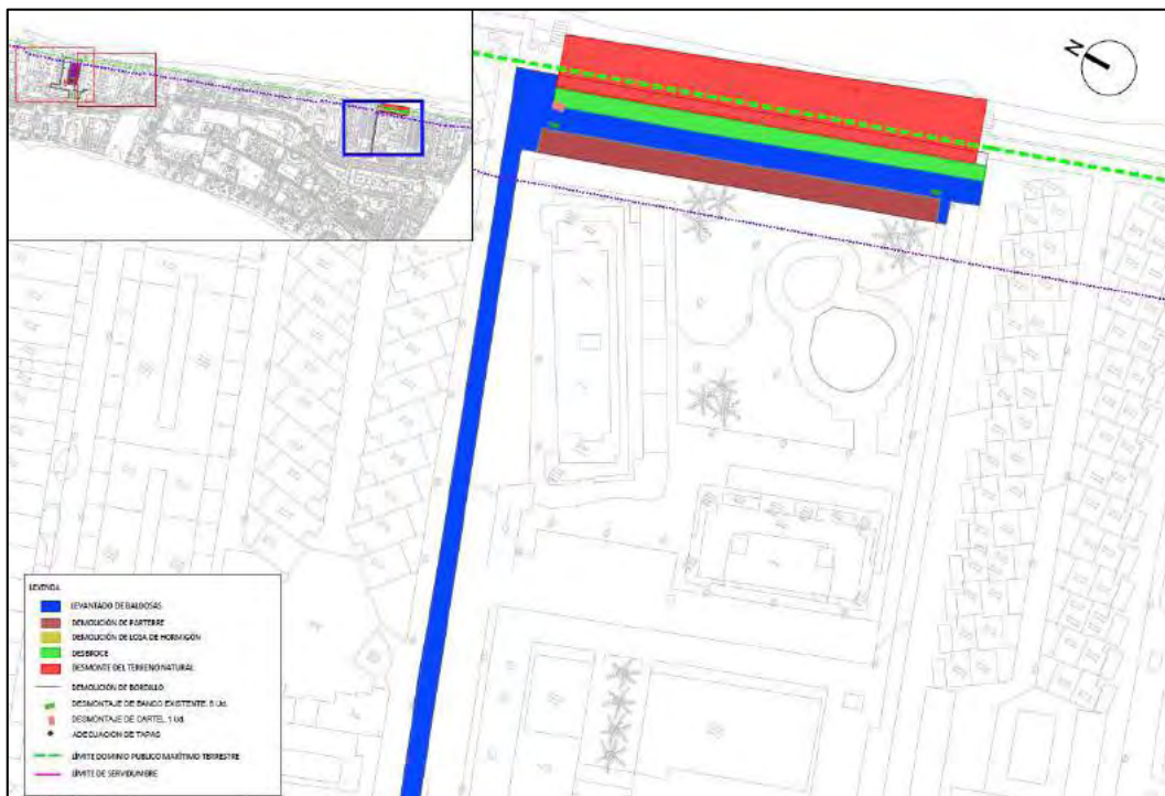
Planta demoliciones. Plaza Zoco Levante.
