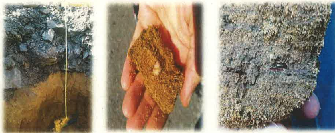
Imagen 31: Calicata C-3, con rellenos antrópicos hasta cota -0,90 m sobre nivel principal de arena con restos conchas, y presencia a nivel inferior de limos con restos vegetales (Ingek).
