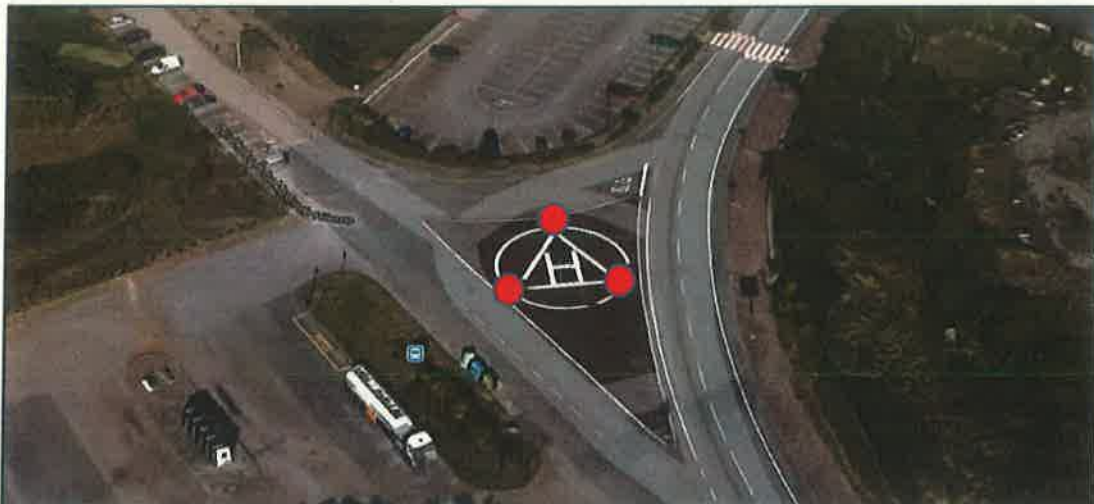
Figura 6. Puntos del helipuerto de la Playa de La Arena (en rojo) utilizados para la calibración de los planos topográficos de referencia.
