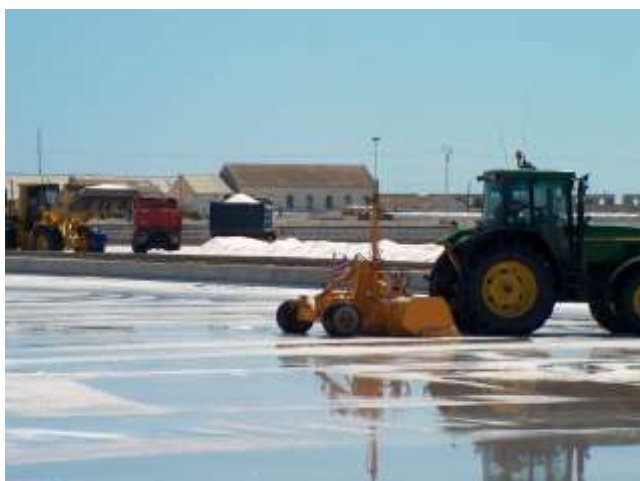
Grada o "trailla" accionada por tractor, distribuyendo la sal remanente y nivelando el piso de la balsa
