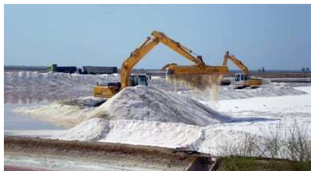
Retroexcavadora apilando sal para su escurrido previo a la carga
