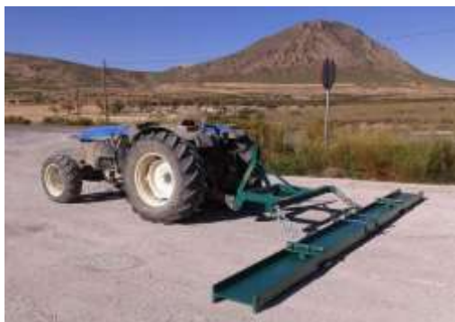
“Tablón” o viga usada también para extender la sal remanente y en otros trabajos preparatorios
