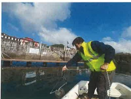
Figura 11. Toma de muestras mediante draga Van Veen.
