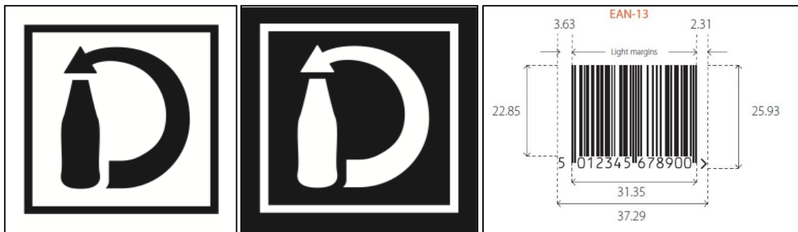
Figura 74. Etiquetado del sistema de reembolso en positivo y en negativo (izquierda), tamaño del etiquetado(derecha).
