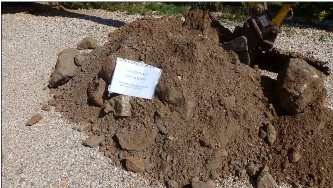
Fotografía nº 2.- Terrenos excavados en la calicata.
