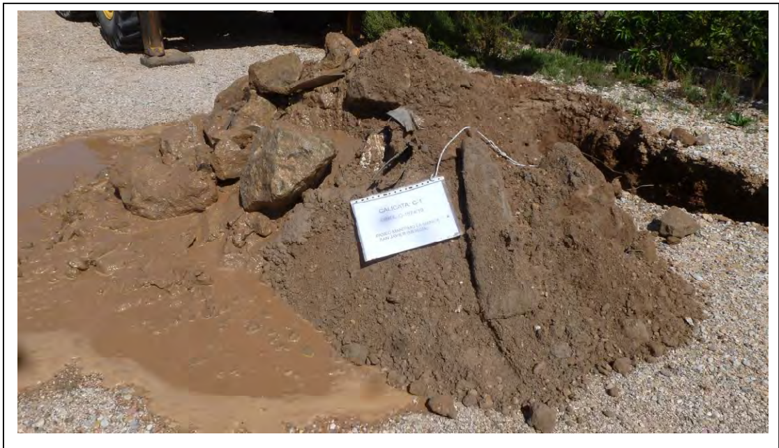
Fotografía nº 6: Rellenos antrópicos excavados en la calicata.
