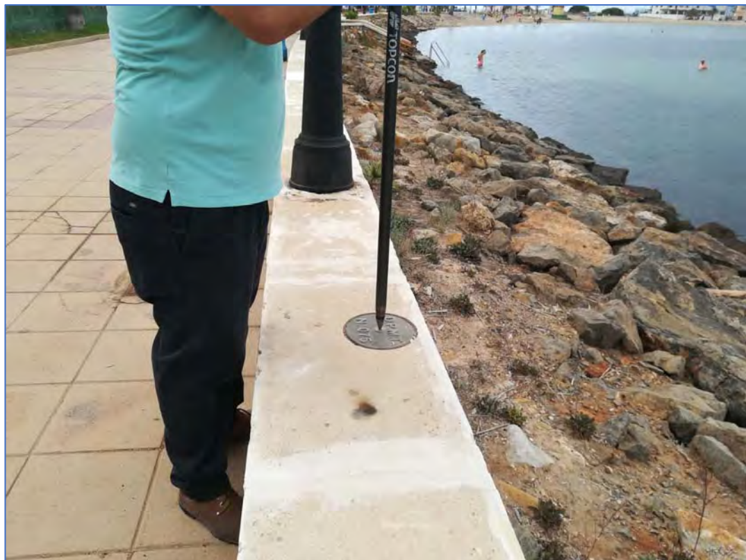
Imagen 23. Levantamiento con GPS del hito 076 en zona de paseo marítimo ejecutada
