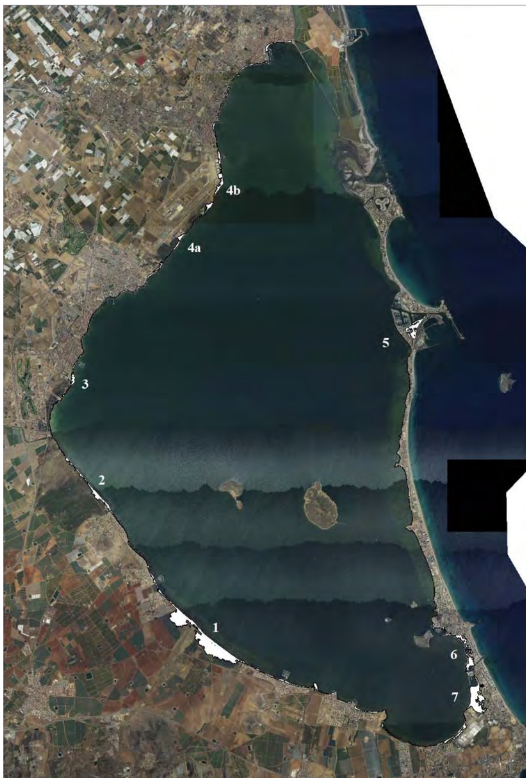
Zonas inundables en la ribera del Mar Menor, para la cota de inundación +1 m relativa al Nivel Medio del Mar en Alicante.
