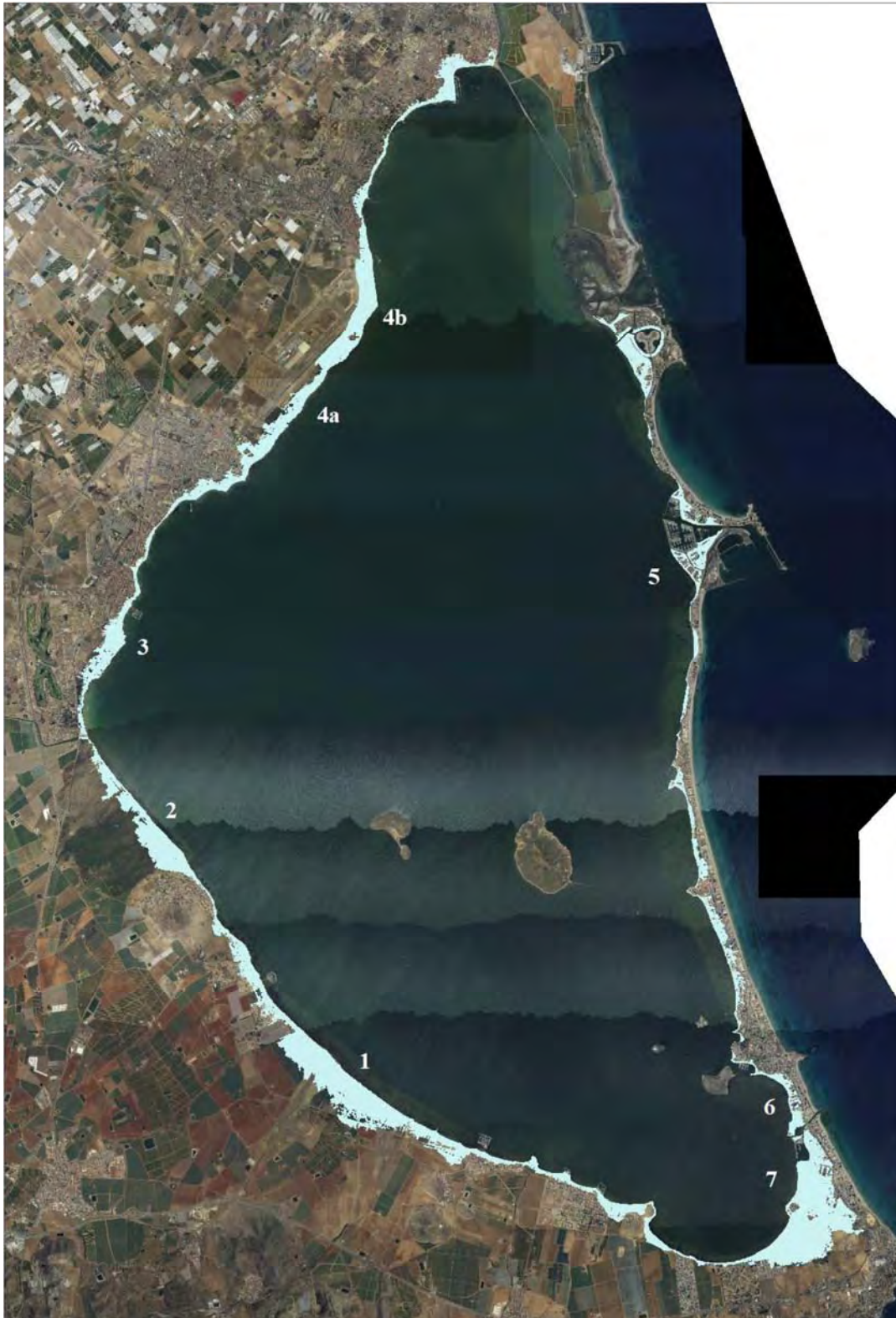
Zonas inundables en la ribera del Mar Menor, para la cota de inundación +2.5 m relativa al Nivel Medio del Mar en Alicante.
