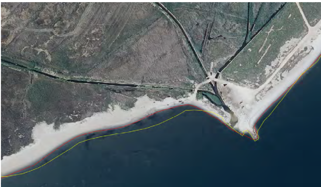
Regresión de la línea de costa entre el año 2009, (amarillo) y el 2019, (rojo). Ortofoto base año 2019.
