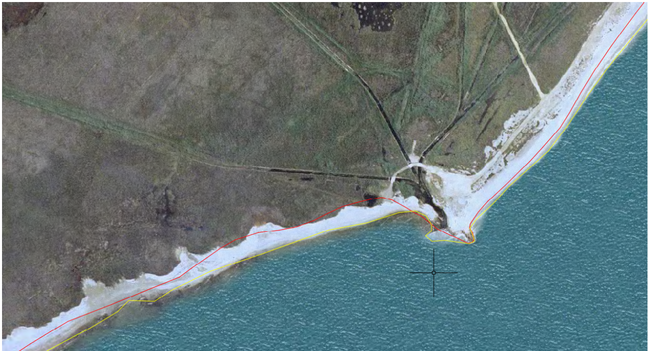
Regresión línea de costa año 2003, (amarillo) y el 2019, (rojo). Base ortofoto año 2003.
