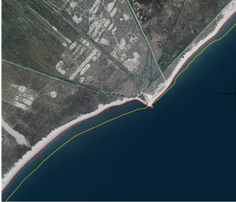
Regresión de la línea de costa entre 1956, (amarillo) y 2019, (rojo). Base ortofoto año 2019.
