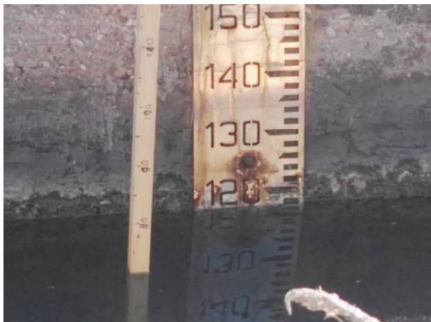
Calado existente actualmente en acequias 75 cm Medidor localizados indica 120 y 110 cm respectivamente
