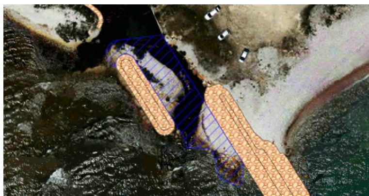
Zona de remoción de gravas y escolleras.
