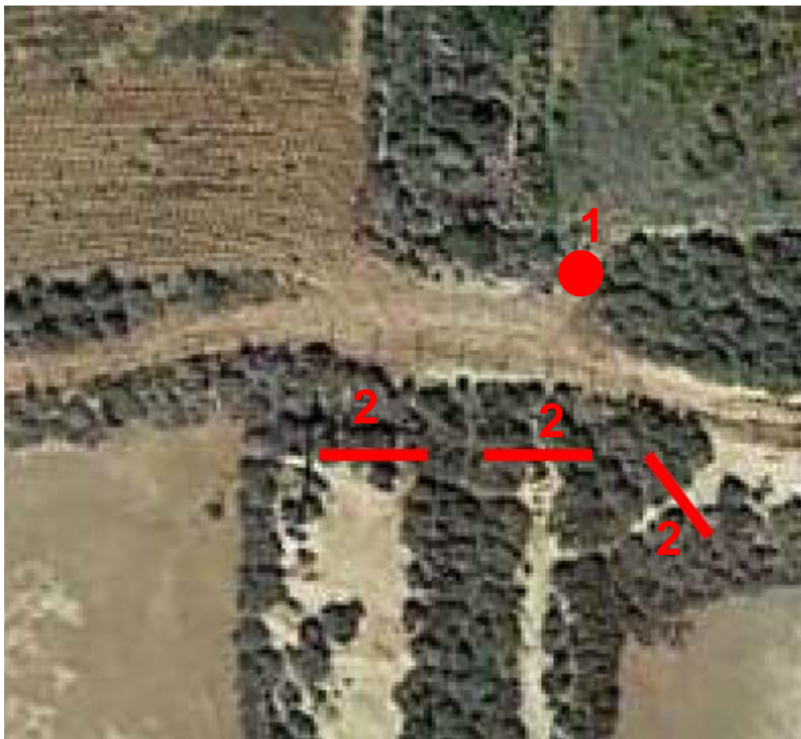
Fotograma 7. Elementos que se proyectan en el entorno inmediato de la desembocadura del cauce a la zona húmeda. 1- Panel informativo de madera. 2- Vallas de 4 x 1,2 m de madera. Detalle del emplazamiento del panel en foto 9. Detalle del emplazamiento de las vallas en fotos 10 y 11.
