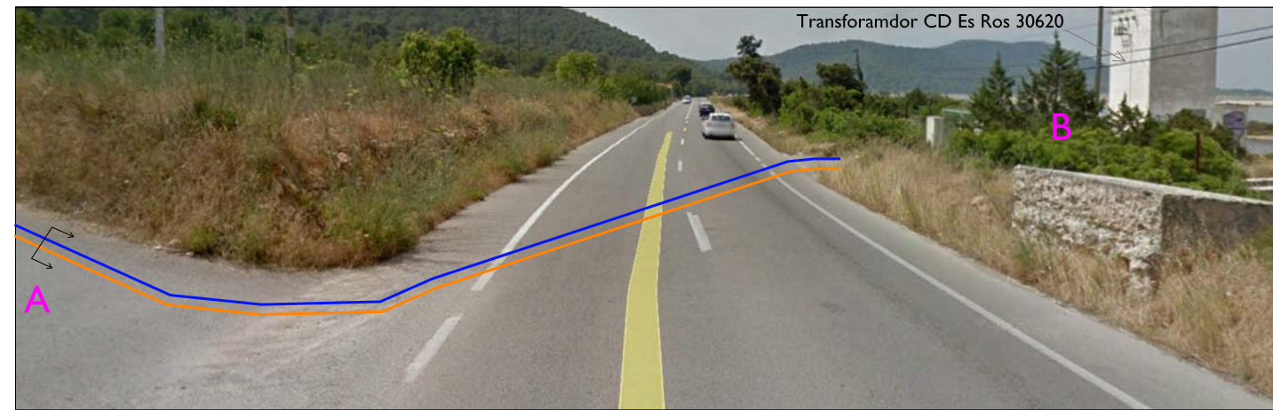
Entrada de perforación en topo, pasando por debajo de la carretera y el canal hasta llegar a la zona del transformador CD Es Ros 30620 (f 01)
