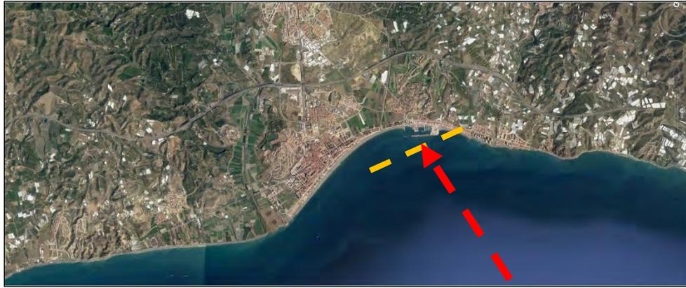
Alineación de la costa y emplazamiento de la dirección del Flujo Medio de Energía, casi perpendiculares. Alineación media en torno a  $160^{\circ}$ - $170^{\circ}$ .
