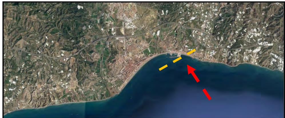
Alineación de la costa y emplazamiento de la dirección del Flujo Medio de Energía, casi perpendiculares.
