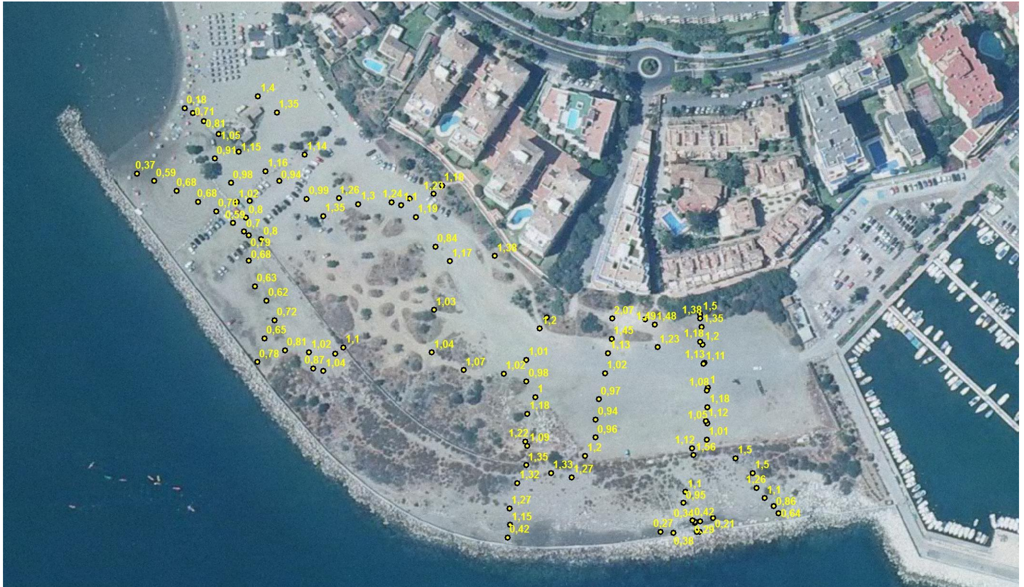
Levantamiento taquimétrico G.P.S. del terreno de la zona de estudio.
