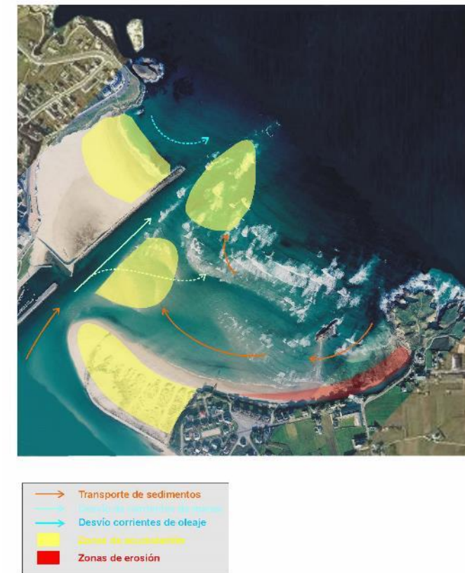
Figura 3.8 “Esquema general del impacto causado por el encauzamiento del canal sobre la ensenada
