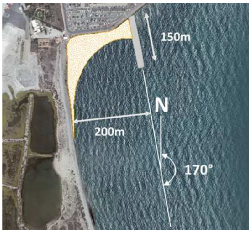
Imagen 14. Alimentación artificial y construcción de espigón. Fuente: Proyecto de acondicionamiento de las playas de La Llana . IH Cantabria (2.019)
