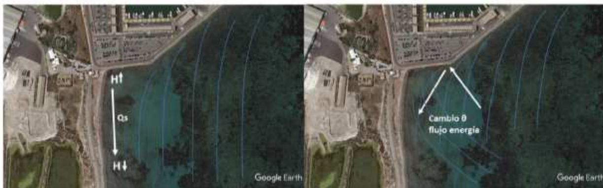
Imagen 54. Imagen izquierda: efecto “match stem”; Imagen derecha: reflexión del oleaje y cambio de dirección del flujo de energía. Fuente: IH Cantabria
