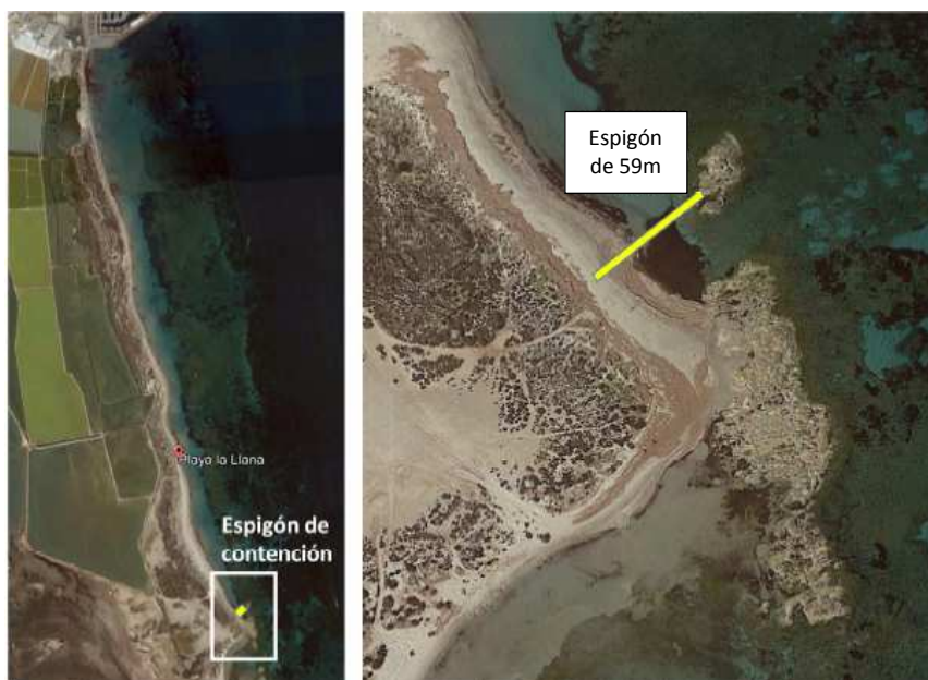
Imagen 17. Espigón de contención de arena al final de la playa, permitiendo el paso en la playa entre el dique y la duna. Fuente: Actualización del proyecto de acondicionamiento de las playas de La Llana . IH Cantabria (2.019)
