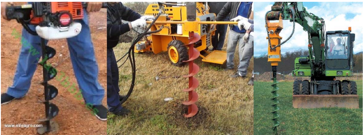
Fotos 6 a 8. “Mini” con barrena hoyadora (derecha), y hoyadora manual, para colocación de postes.
