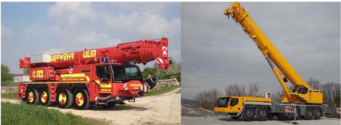
Fotos 14 y 15. Grúa móvil extensible hasta 70 m, para construcción de islote artificial.
