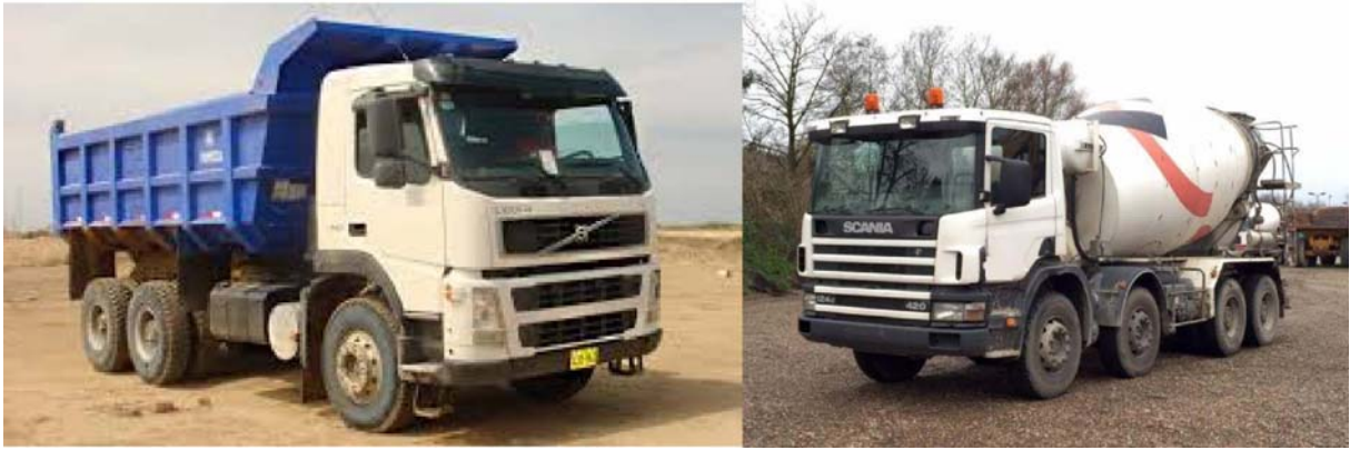
Fotos 9 y 10. Camión volquete (izquierda) para carga de materiales, y camión hormigonera para el rellenado de zanjas.
