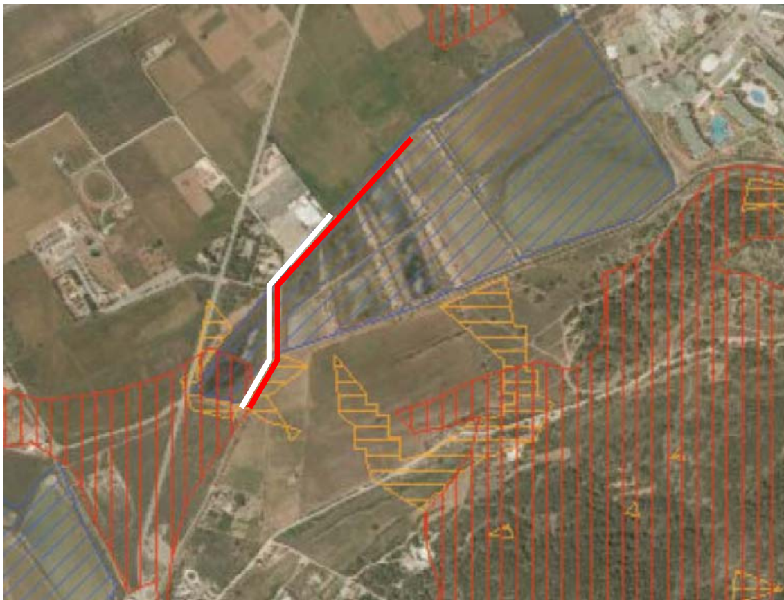
Fotograma 6. Coincidencia de líneas soterradas de MT (rojo) y telefonía (blanco), con zonas catalogadas como APR de inundación.
