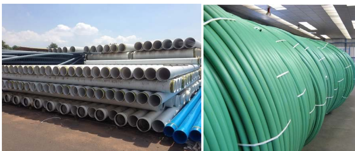
Fotos 23 y 24. Ejemplo de acopios de tuberías de PVC corrugadas y lisas (izquierda) y de polietileno para fibra óptica (derecha).
