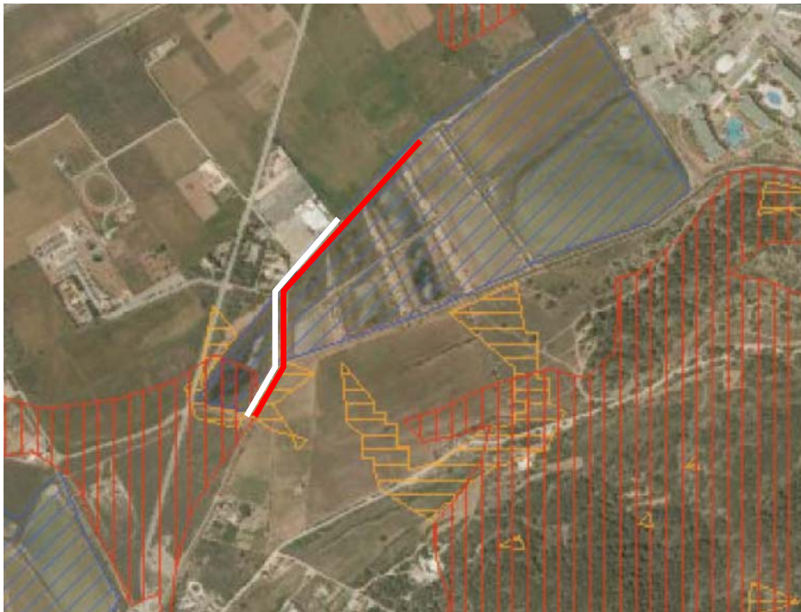
Fotograma 8. Coincidencia de líneas soterradas de MT (rojo) y telefonía (blanco), con zonas catalogadas como APR de inundación.
