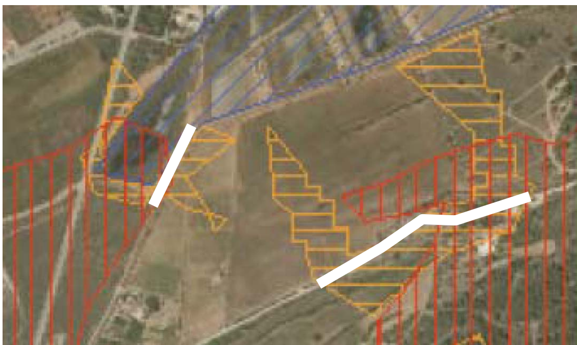
Fotograma 5. Tramos de zanjas afectados por APR de erosión, siempre en terreno llano.
