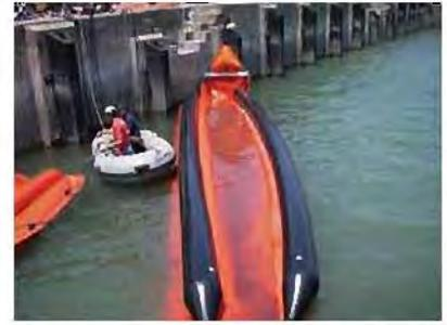
Foto 8. Depósito flotante
