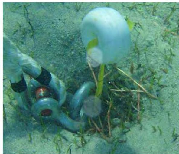
**Línea de unión:** sistema SEAFLEX. Sistema elástico de amarre, resistente a la corrosión, compuesto por un disco de poliamida, tendones de forma, un grillete de acero inoxidable y un cabo bay-pass de poliéster de 32 mm que limita el estiramiento del tendón al 85 % de su longitud original.
