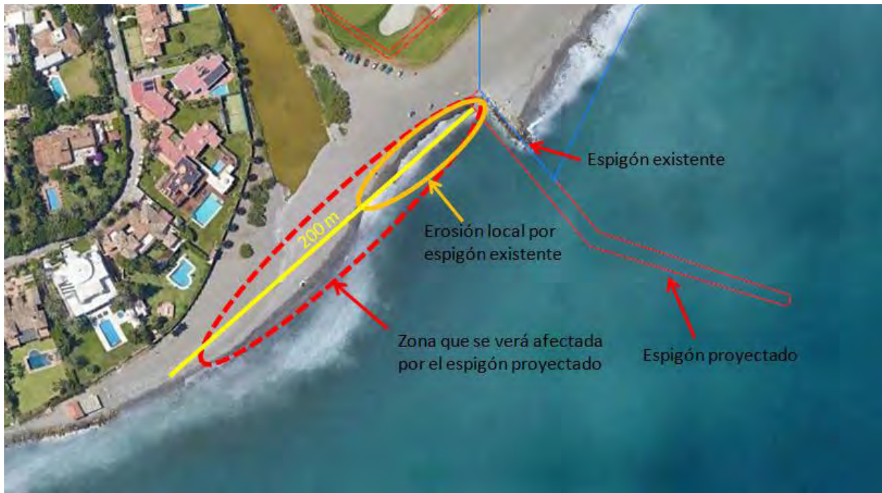
Ilustración 153. Zona afectada por erosión debida al proyecto
