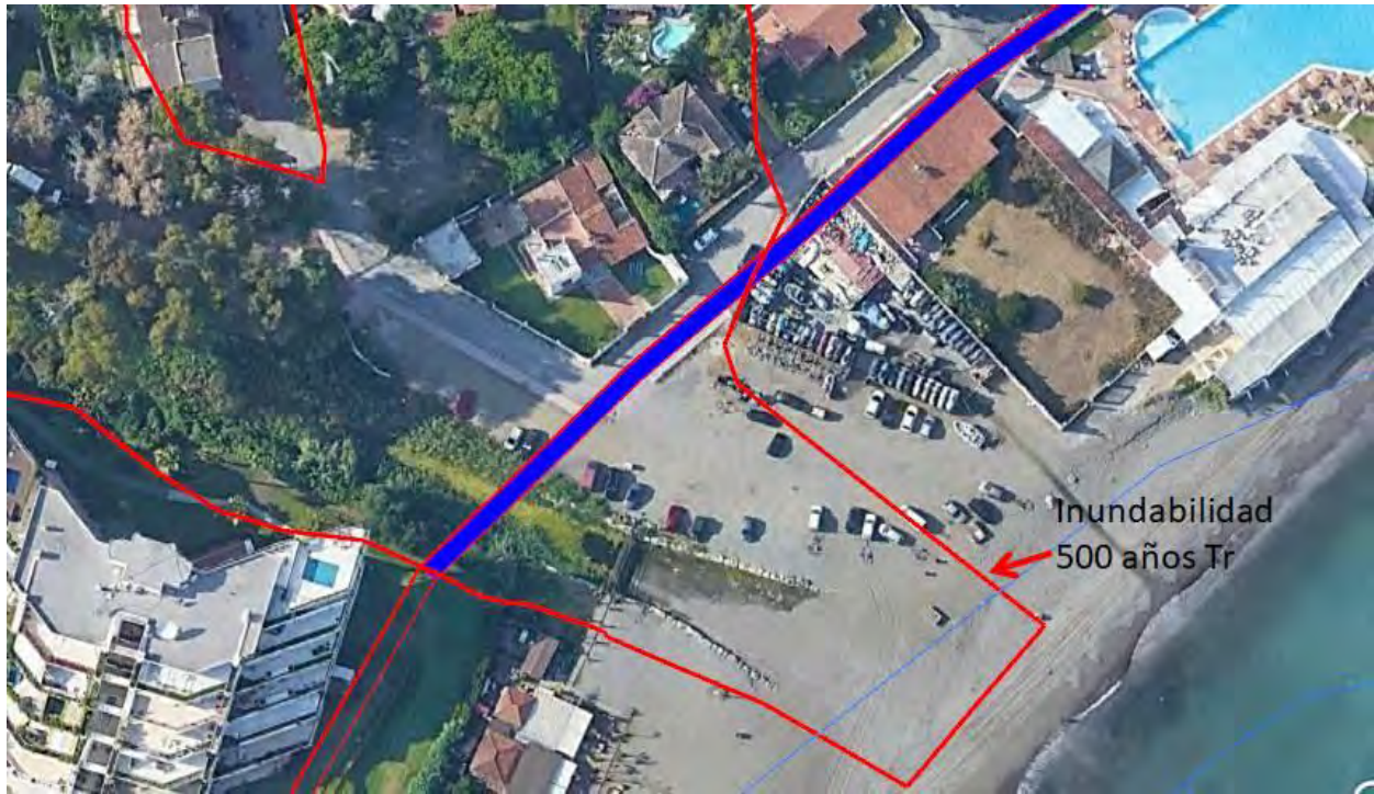
Ilustración 157. Ubicación de la pasarela (relleno azul indica pasarela elevada) en la zona del arroyo del Chopo y relación con el ámbito de inundabilidad del periodo de retorno de 500 años
