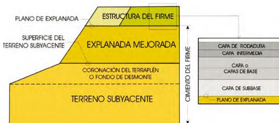
Imagen 5.1.4.1-1. Esquema de composición de las estructuras de firme y explanada 68
