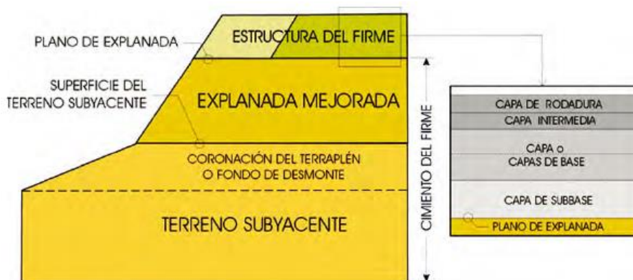
Imagen 6.4.1-1. Esquema de composición de las estructuras de firme y explanada 132
