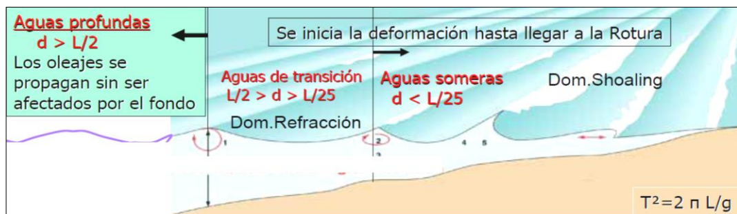
Imagen 2.3: Deformación del oleaje desde aguas profundas hasta aguas someras; proceso de rotura del oleaje
