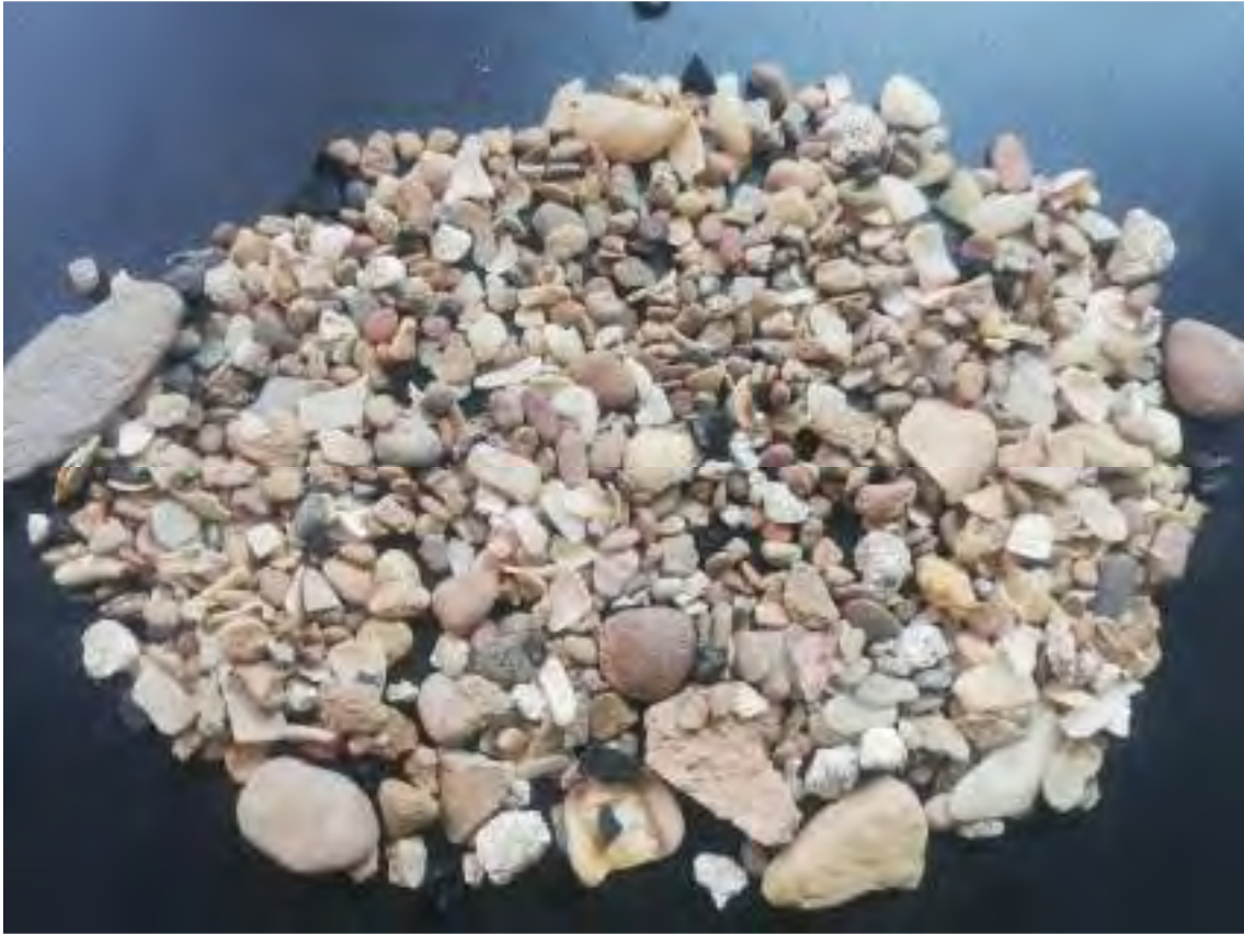
Fotografía nº 5: Calicata C-3 – 0,60-0,90 – Fracción Grava
