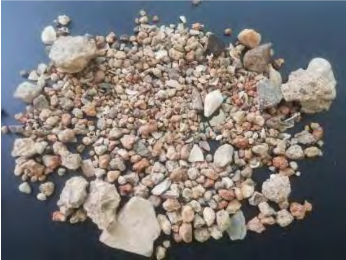
Fotografía nº 1: Calicata C-1 – 0,75-0,90 – Fracción Grava
