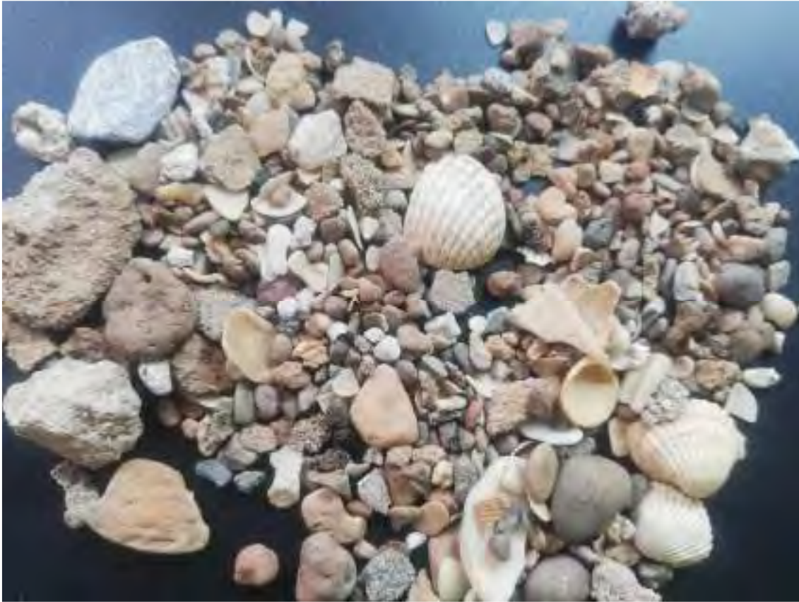
Fotografía nº 3: Calicata C-2 – 0,40-0,65 – Fracción Grava
