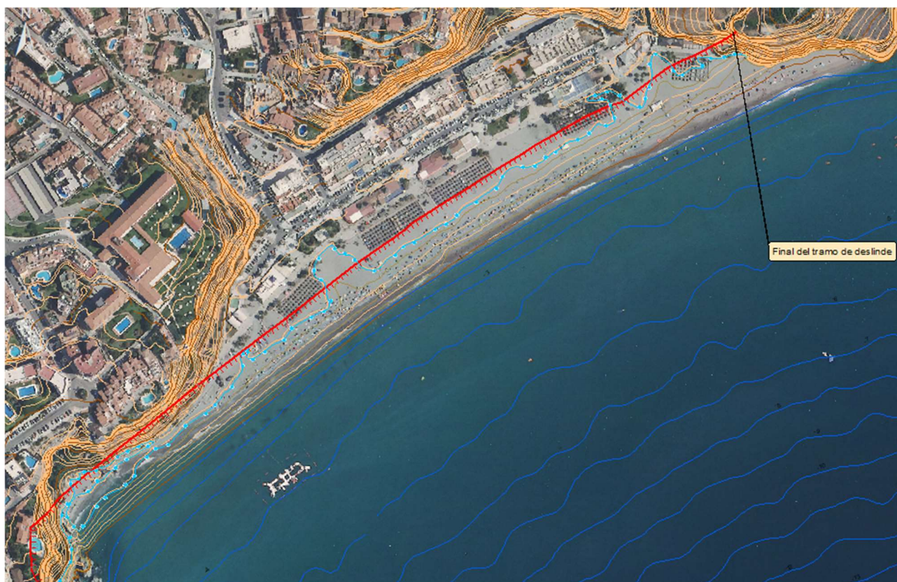
Representación gráfica de los alcances calculados mediante el C.E.M. (en rojo) y la cota de inundación mediante la fórmula de Nielsen-Hanslow (1991) corregida con los factores de Van der Meer y Jansen (en azul).
