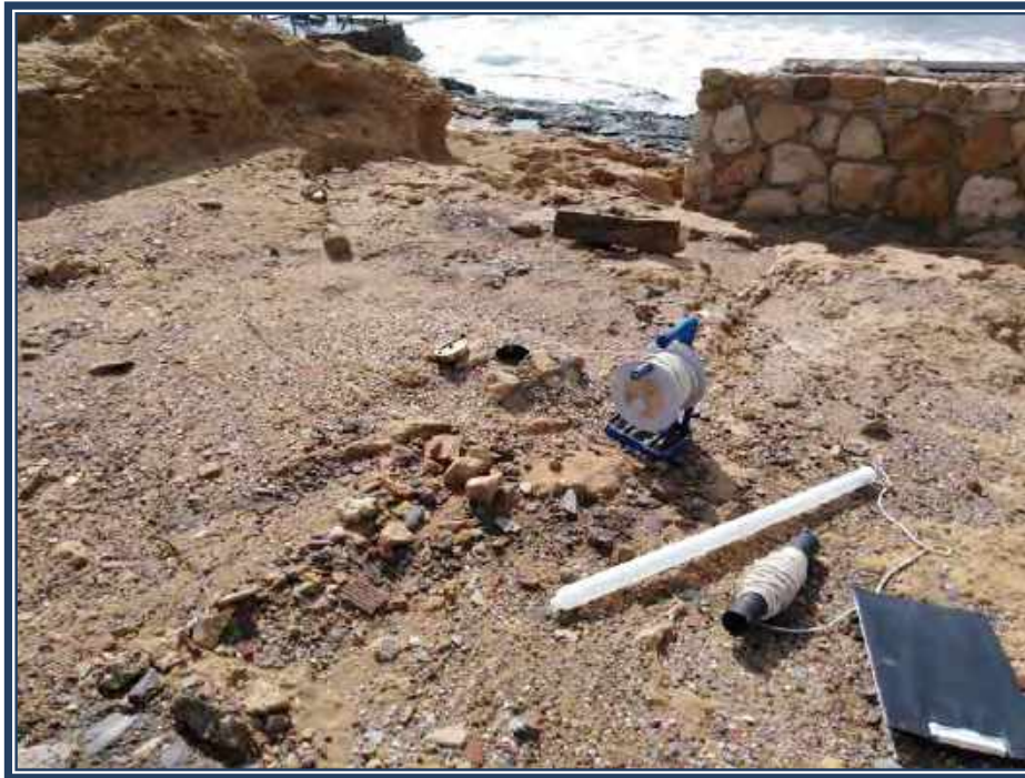
MEDICIÓN DEL NIVEL FREÁTICO EN PZ-01
