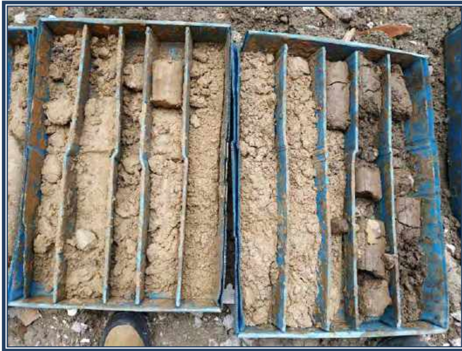
CAJAS DE TESTIGOS DEL SONDEO PZ-2 9,0-12,0 m
