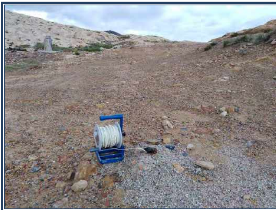
MEDICIÓN DEL NIVEL FREÁTICO EN PZ-02
