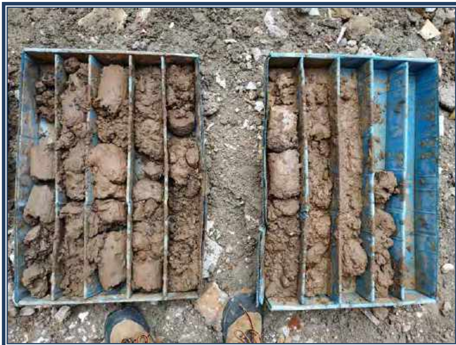
CAJAS DE TESTIGOS DEL SONDEO PZ-2 12,0-20,0 m
