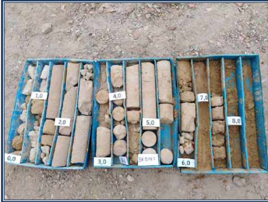
CAJAS DE TESTIGOS DEL SONDEO PZ-1 0,0 – 9,0 m
