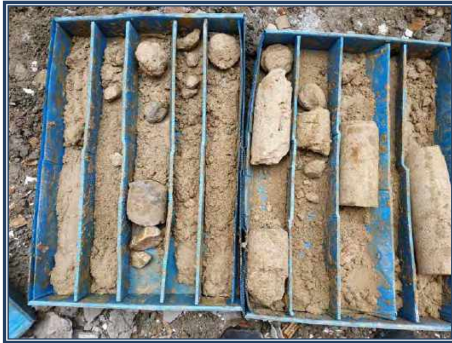
CAJAS DE TESTIGOS DEL SONDEO PZ-2 0,0-6,0 m
