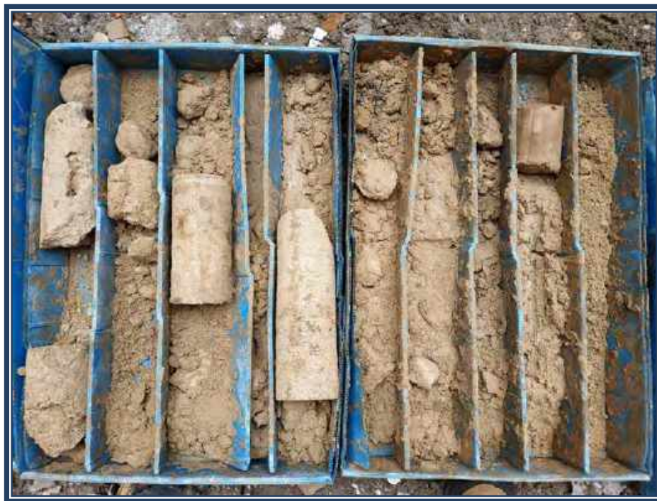
CAJAS DE TESTIGOS DEL SONDEO PZ-2 6,0-9,0 m
