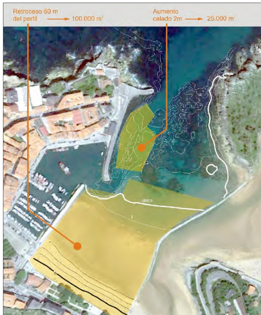
Figura 5.3 – Dragado a ejecutar en la playa de Isuntza para la mejora del canal de acceso al puerto de Lekeitio.
