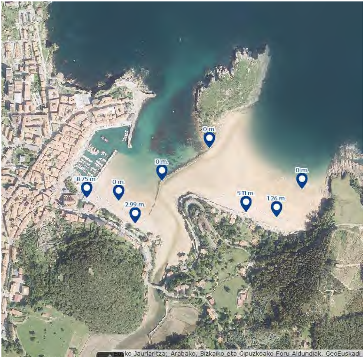
Figura 2. Cotas correspondientes a la referencia topográfica actual (NMMA: REDNAP 2008) lo que equivaldría a un aumento de hasta 2 m en el nivel del mar a escala geomorfológica ingenieril (a 200 años)
