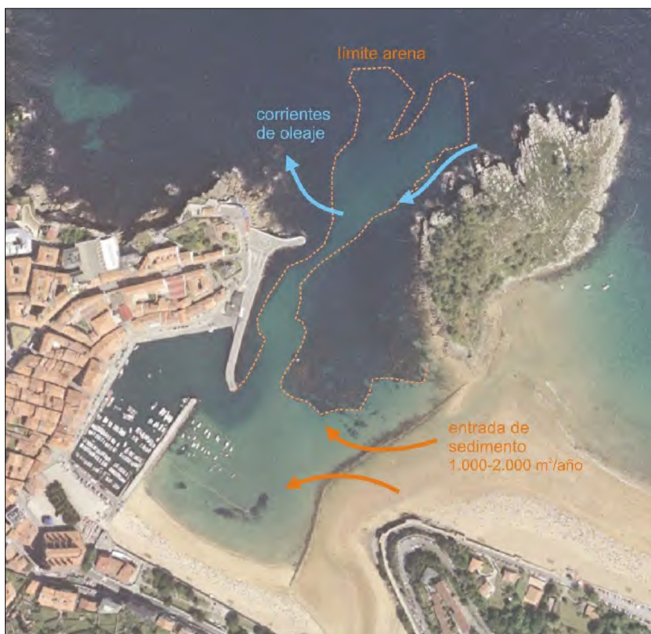
Figura 5.4 – Corrientes y entrada de sedimento en el entorno de la ensenada.
