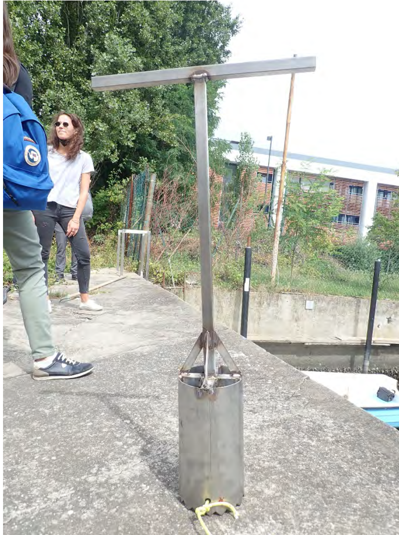
Imagen 1. Perforadora utilizada para realizar la extracción y trasplante de las diferentes especies
