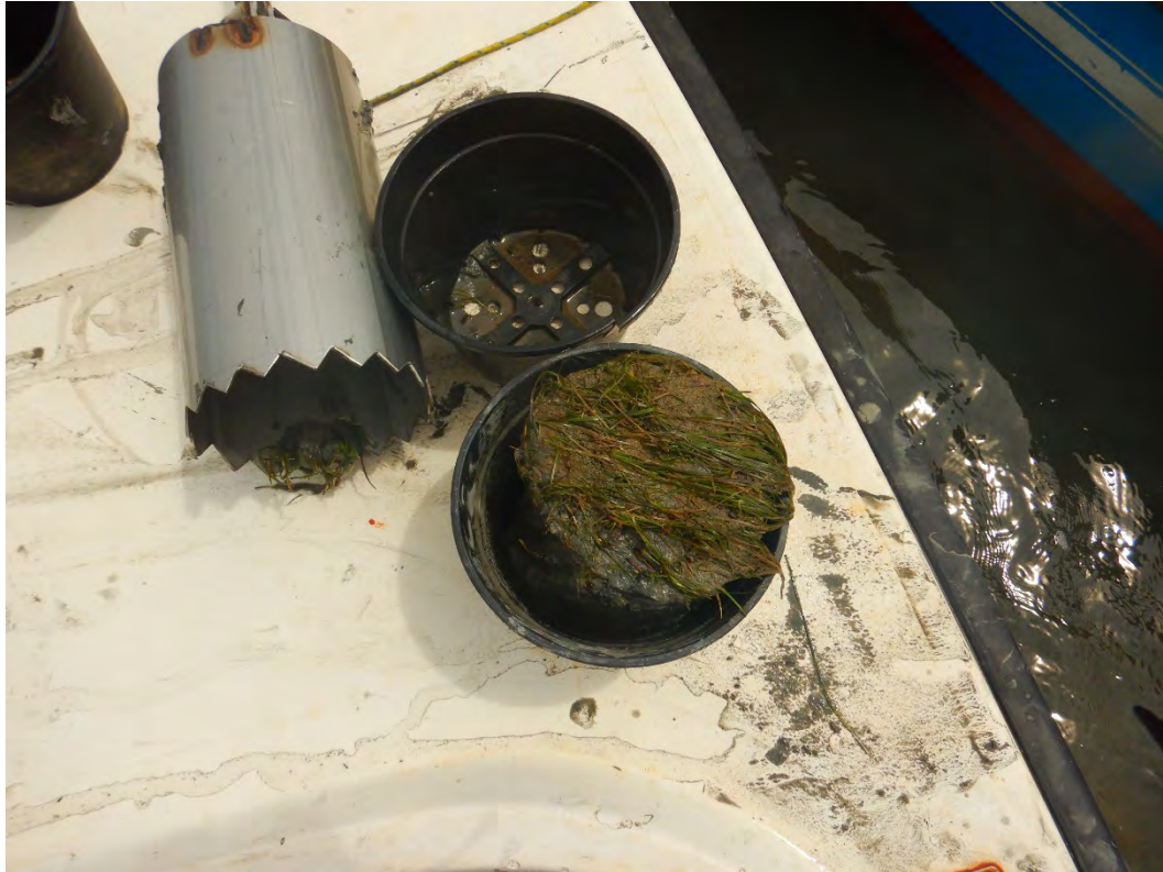
Imagen 4. Perforadora y tepe situado en cubo para su posterior trasplante
