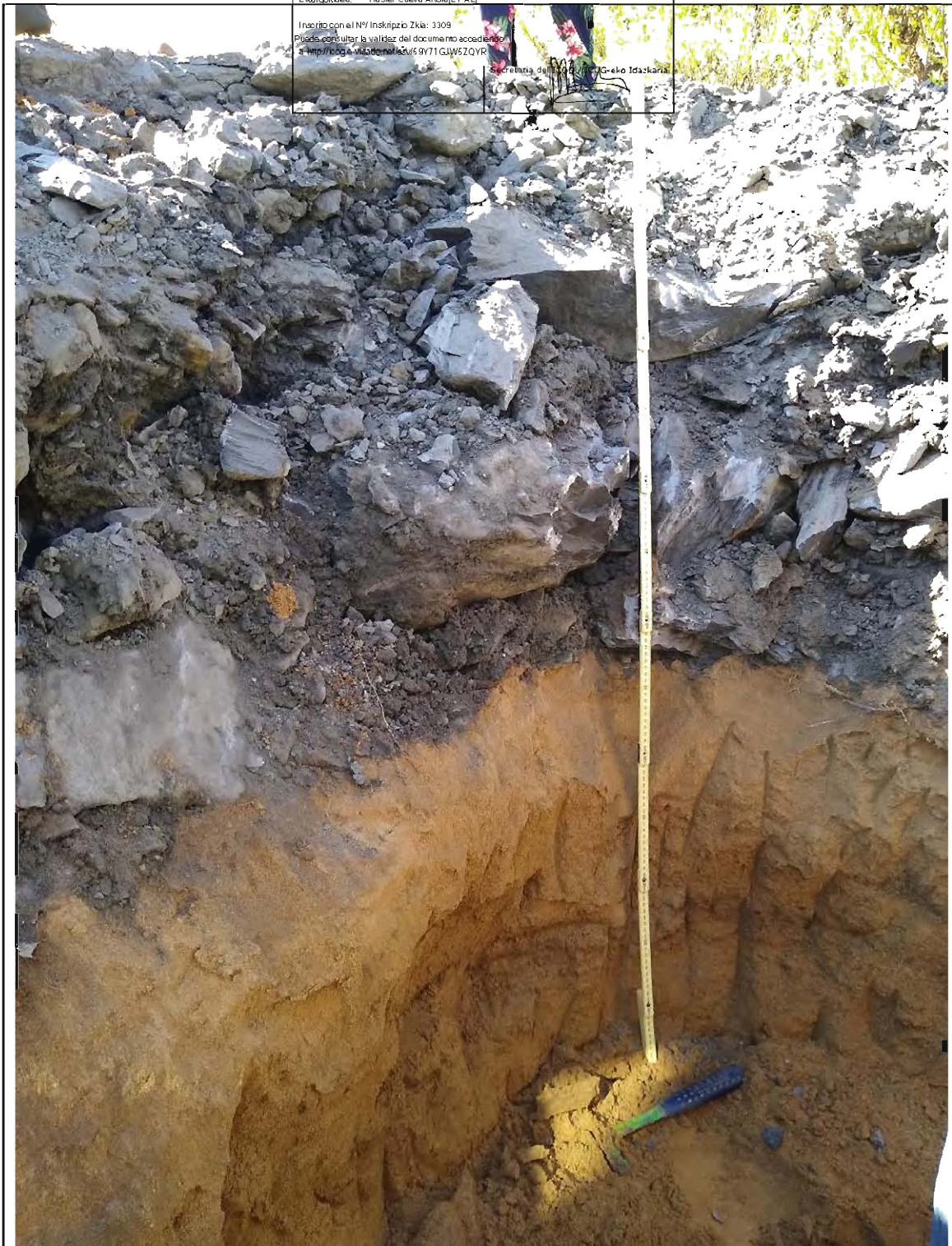
Detalle de metros superficiales de cata 3. Ver nivel bandeado de limo 1,30 metros de profundidad. Calicata C3
