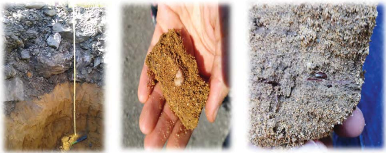
Imagen 31: Calicata C-3, con rellenos antrópicos hasta cota -0,90 m sobre nivel principal de arena con restos conchas, y presencia a nivel inferior de limos con restos vegetales (Ingek).
