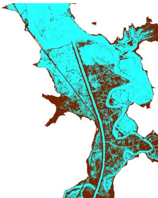
Figura 6.1.- Inundación potencial por hipsometría de la marea considerada (no todos los puntos de cota inferior a 2.20 son accesibles, dado que hay zonas amunadas, hay afecciones del ferrocarril, etc.
