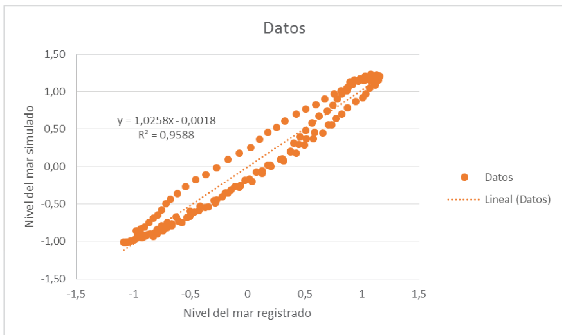
Figura 59. Comparación entre el nivel de marea registrado y el simulado el 23/10/2014.
