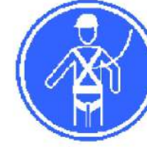
PROTECCIÓN INDIVIDUAL OBLIGATORIA CONTRA CAÍDAS
