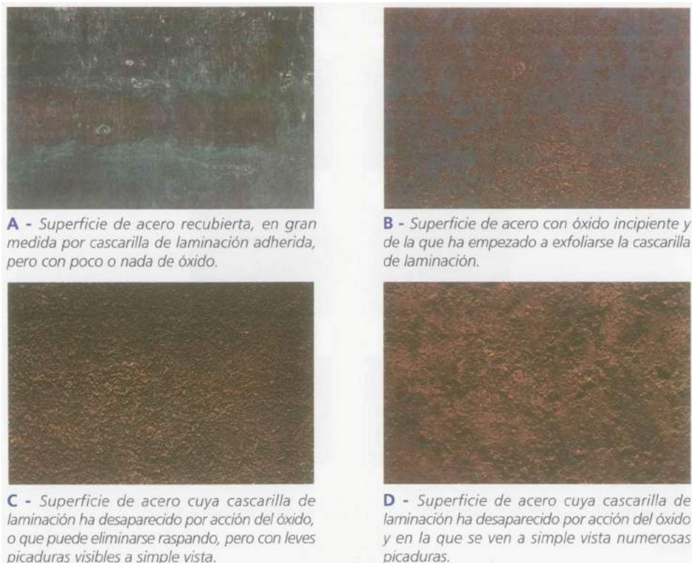
Figura 1.- Patrones fotográficos del grado de óxido
