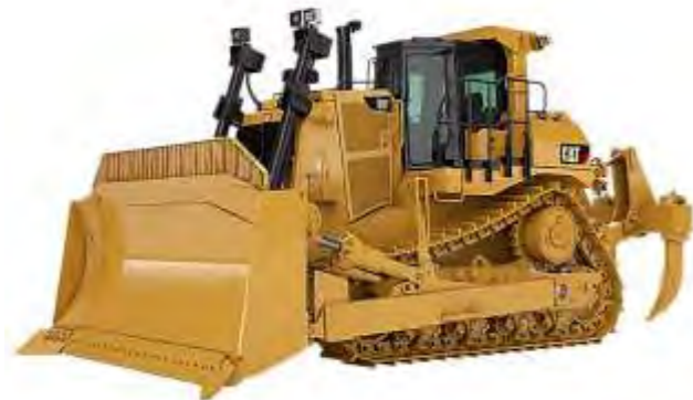
Ilustración 4. Maquinaria de arranque y extendido
