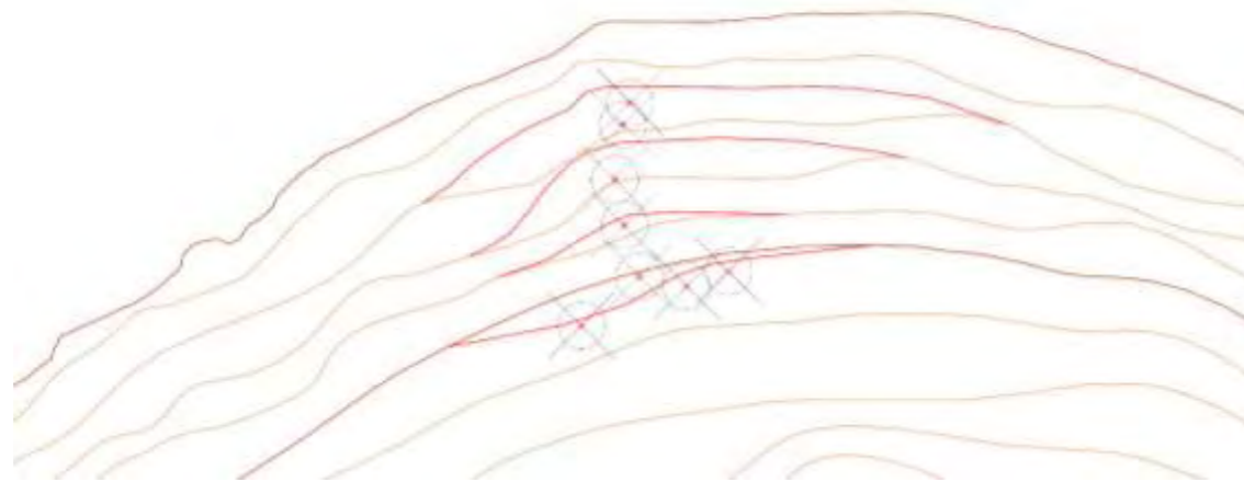
Ilustración 5. Desplazamiento del perfil en la zona del espigón
