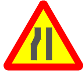
TP-17B ESTRECHAMIENTO DE CALZADA POR LA IZQUIERDA
