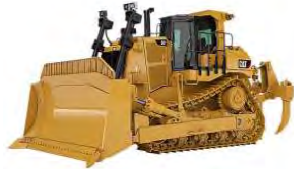
Figura 13. Maquinaria de arranque y extendido
