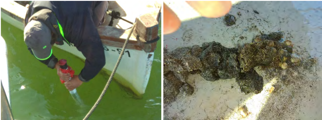
Figura 2. (a) Toma de Testigo de sedimentos.(b) Testigo de sedimentos.
