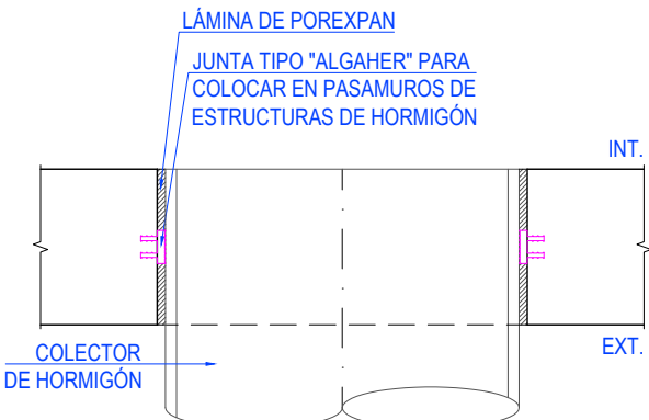
DETALLE DE JUNTA EN COLECTORES DE HORMIGÓN
