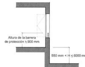
Las barreras de protección, que protegen diferencias de cotas inferiores a 6 m, tienen una altura mínima de 900mm., medida verticalmente desde el nivel del suelo o –en el caso de escaleras- desde la línea de inclinación definida por los vértices de los peldaños, hasta el límite superior de la barrera.
