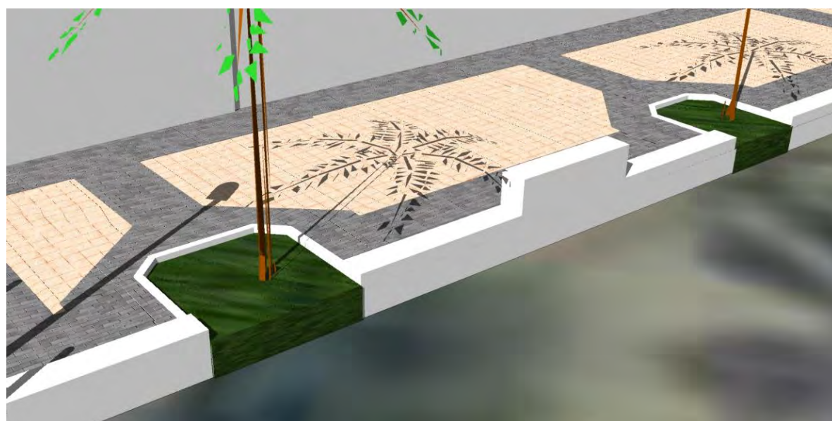
Imagen 3D Detalle muro contención, elevación para bancos y encuentro con jardineras
