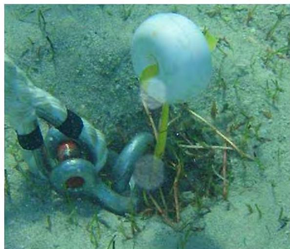
Para los barcos de esloras  $25 \text{ m} < L \leq 40 \text{ m}$ , se procederá a la instalación de dos anclas por amarre, distantes 4 m entre sí y conectadas mediante un cable de acero inoxidable AISI 316 de  $1 \times 19 \text{ } \varnothing 6 \text{ mm}$ , que permitan el trabajo conjunto y equitativo de los dos.
