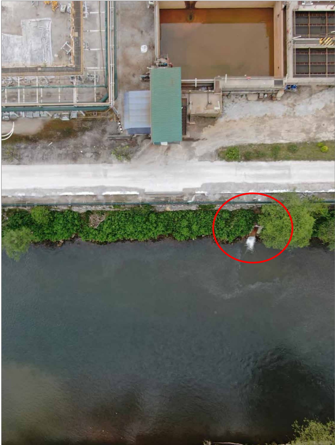
Fotografía 20. Punto de Vertido 3: Vista área, desde margen izquierda de la Ría de San Martín, de la salida actual de agua tratada tras EDARI.
