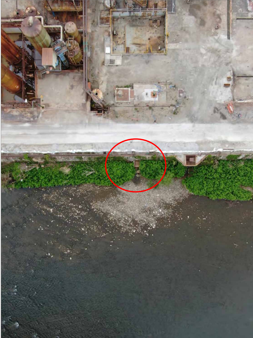
Fotografía 11. Punto de Vertido 2 de SOLVAY QUÍMICA, S.L.: Salida de la alcantarilla secundaria de achique en grandes avenidas en la margen derecha de la Ría de San Martín de la Arena.
