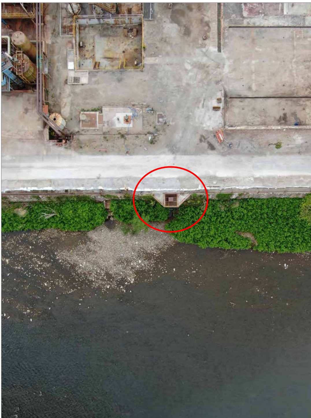
Fotografía 3. Punto de Vertido 1 de SOLVAY QUÍMICA, S.L.: Salida de la antigua alcantarilla general en margen derecha de la Ría de San Martín de la Arena.
