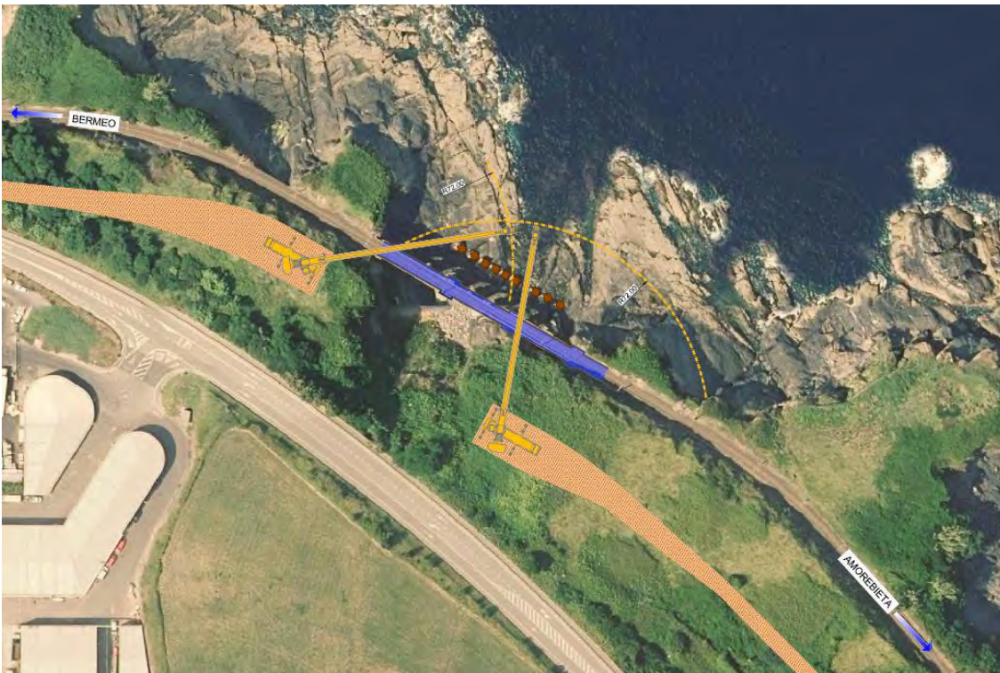
Figura 111. Posibles pistas de acceso para la ejecución de los trabajos de protección marítima del viaducto.
