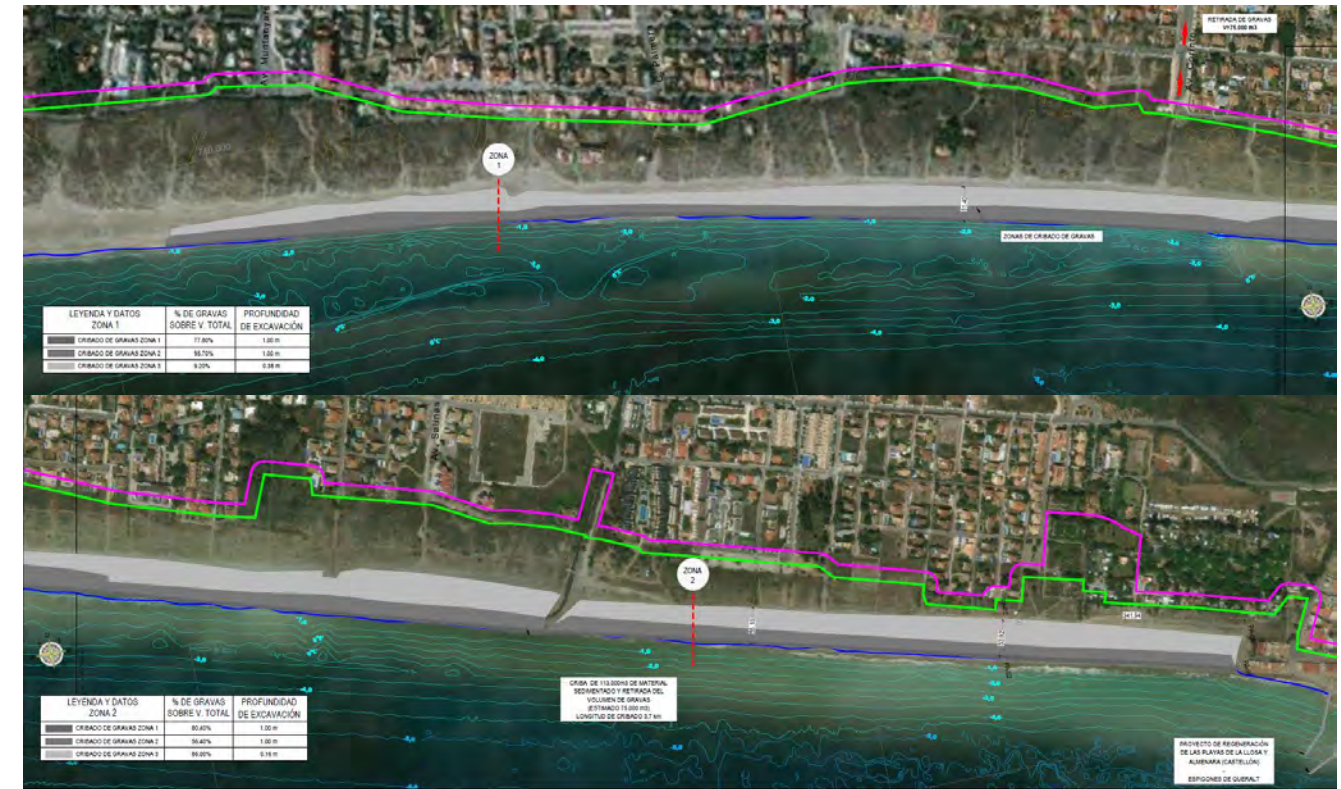
Ilustración 14. Zona de cribado, extracción (arriba) y vertido de gravas (abajo).
